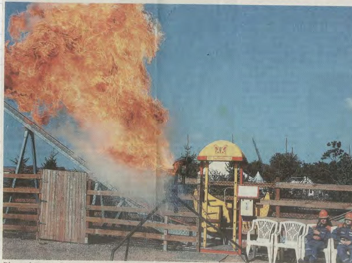
Die ungeheure Wucht einer Fettexplosion, eindrucksvoll demonstriert: Solch riesige Flammen schlagen aus der Friteuse, wenn nur ein Viertelliter Wasser in heißes Fett geleert wird.
